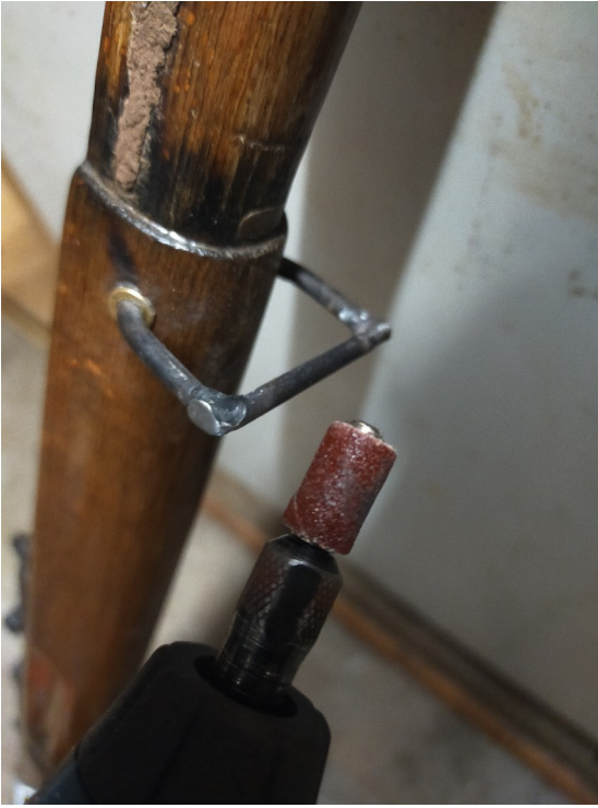
Petit à petit, ponçage et régularisation des 2 boucles créés.
