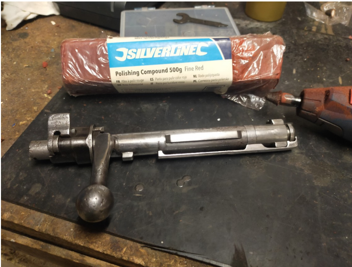
Polissage de la culasse avec vue en détails de l'avant et l'arrière poli (sécurité drapeau) par rapport à la noix de culasse et au levier dans leur patine grise.
