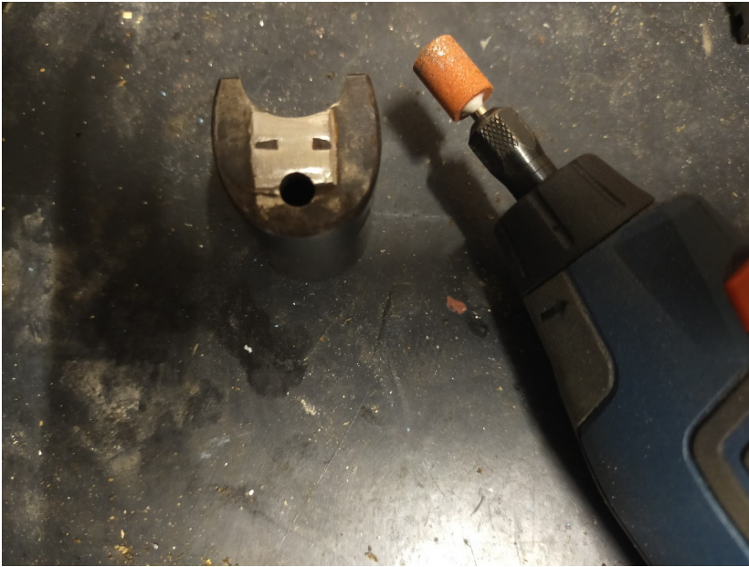
Finition au dremel (meule puis papier de verre) afin de lisser l'ensemble.
