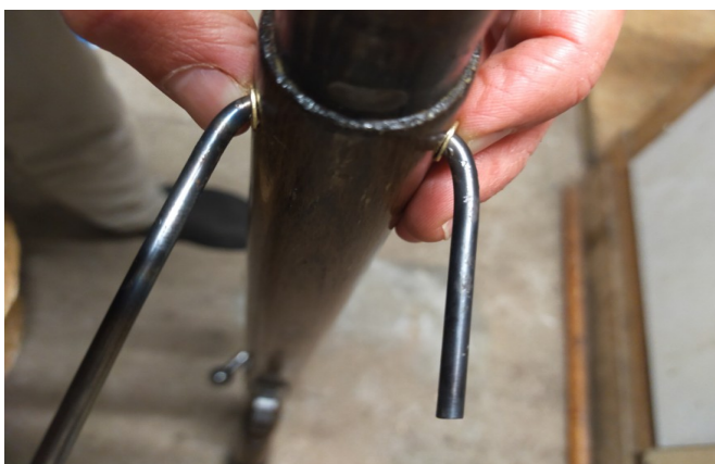
Mise en place des rondelles en laiton.
