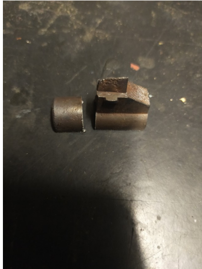
La coupe de la bague pour laisser une forme de demi-lune, puis ponçage du dessous pour maximiser l'adhérence de la soudure.
