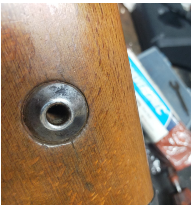
Polissage de rondelle de crosse et de la détente.
