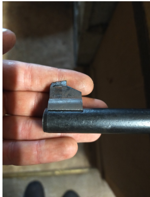
La coupe de la bague pour laisser une forme de demi-lune, puis ponçage du dessous pour maximiser l'adhérence de la soudure.
