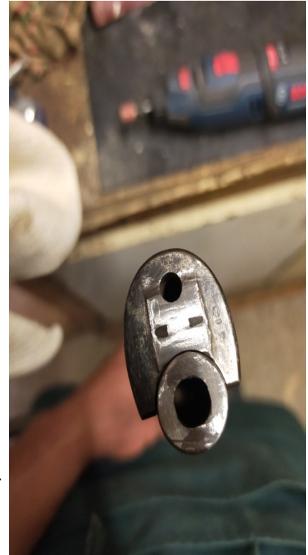
Finition au dremel (meule puis papier de verre) afin de lisser l'ensemble.
