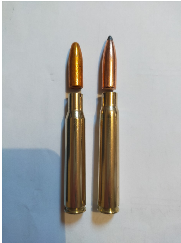
A gauche, un étui de .30-06 avec une balle plomb H&N (munition qui a servi au fromage). A droite, un étui ayant pris la forme de la chambre en 8x64S avec sa future balle Speer.
