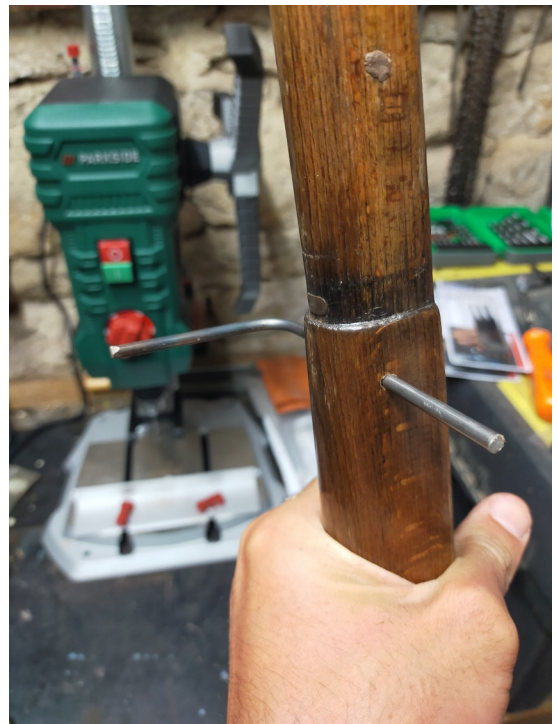
Mise de niveau de la crosse puis perçage, la tige de 4 mm rentre parfaitement.
