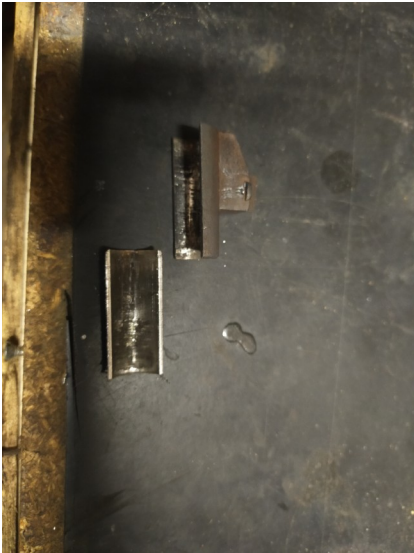
La coupe de la bague pour laisser une forme de demi-lune, puis ponçage du dessous pour maximiser l'adhérence de la soudure.
