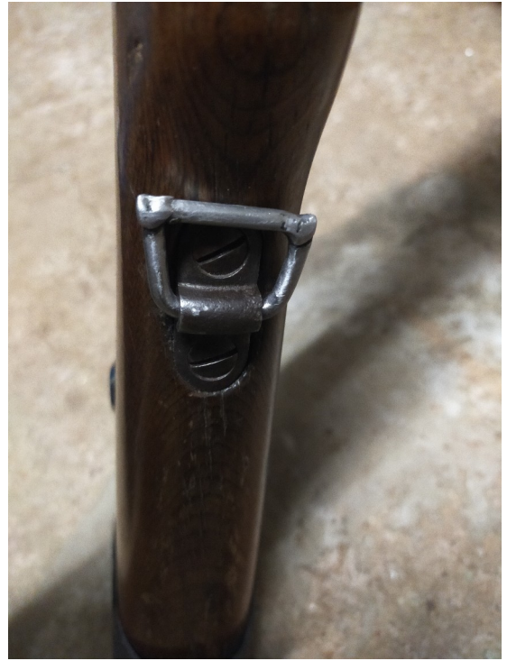
Petit à petit, ponçage et régularisation des 2 boucles créés.
