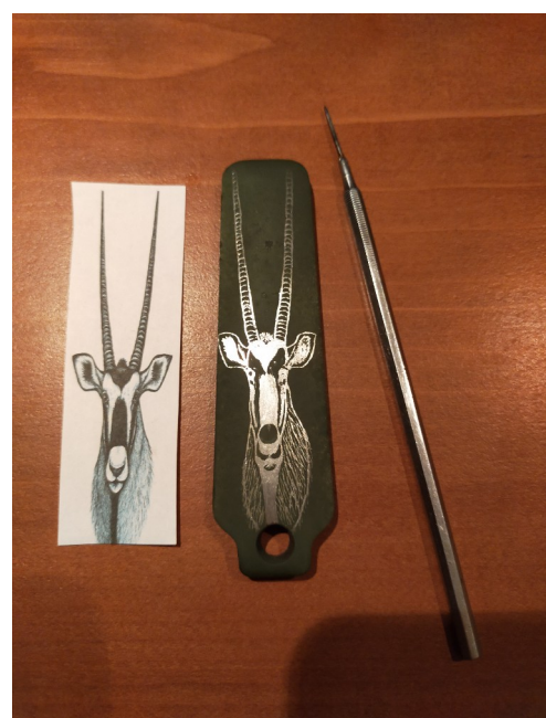
Calquage du dessin et re-transposage de celui-ci sur la plaque de magasin.
