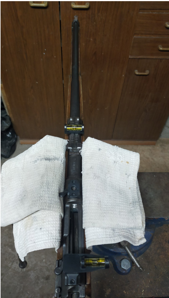
Positionnement de l'arme de niveau, présentation du guidon retravaillé, puis soudure à l'étain.
