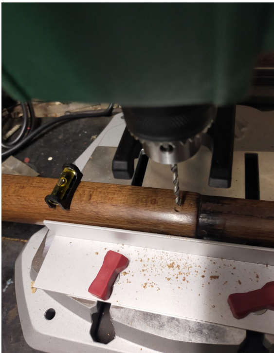
Mise de niveau de la crosse puis perçage, la tige de 4 mm rentre parfaitement.
