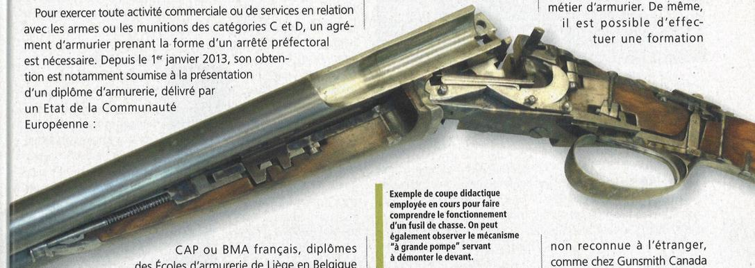
Exemple de coupe didactique employée en cours pour faire comprendre le fonctionnement d'un fusil de chasse. On peut également observer le mécanisme "à grande pompe" servant à démonter le devant.
