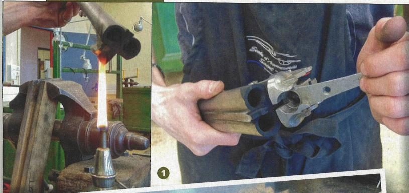
1 - Le basculeur. L'ajustage au noir de fumée permet de travailler avec une tolérance inférieure à 0,02 mm. En claquant la bascule d'un coup sec, le dépôt de carbone s'efface uniquement dans les zones de frottement. Ainsi mis en évidence, les points de contacts blanchis doivent alors être limés et/ou repolis. Et l'opération est répétée jusqu'à l'obtention d'une surface totalement blanche, indiquant un ajustage parfait.
